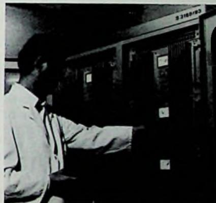
Wie AEG-Telefunken mitteilt, ist dieser 3-kW-UKW-Sender für den Hessischen Rundfunk bisher der weltweit erste Sender dieser Leistungsstufe, der als Verstärkerelemente einzig und alleine Halbleiter enthält.
